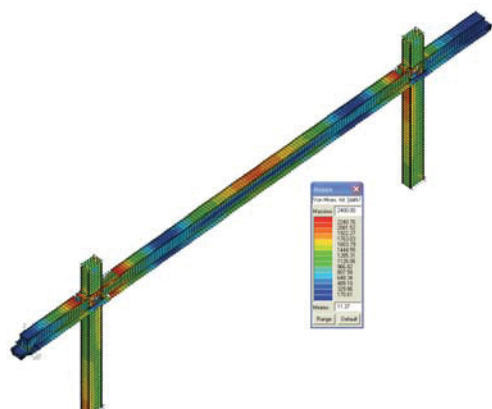
Sforzi Von Mises travi e pilastri
